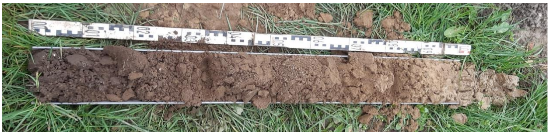
Afbeelding 16 Boorprofiel van boring 1 met v.l.n.r. de subrecente ophoging, de eerdlaag, het plaggendek en de verspoelde en daaronder intacte zandige leem (hoogvloedleem) van het Laagpakket van Wijchen
